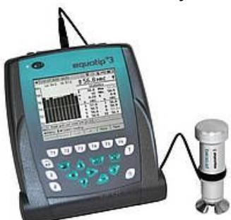
Equistat 3 je razvijen za precizno, brzo i ponovljivo testiranje tvrdoće metala. On poseduje izuzetnu osetljivost kroz malu penetraciju od samo nekoliko µm i zbog toga je naročito prikladan za testiranje tvrdoće metala površinskih slojeva koji su osetljivi na grebanje i uglačanih ili tankih delova , profila i cevi sa debjinom zida koja je ispod 2 mm.
