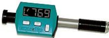
Equotip Bambino 2 je ručni merni uređaj za jednostavno testiranje tvrdoće metala na najrazličitijim geometrijama delova most. On kombinuje modernu elektroniku sa patentiranim udarnim uređajem koji integriše test ciklus u jedan prosti pokret.
