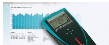
Profoscope<sup>+</sup> je potpuno integrисани detektor armature sa internom memorijom. Radi povećanja efikasnosti na mestu izgrajne ovo unapređenje Profoscope-a pored vizuelizacije armature u realnom vremenu nudi i automatsko prikupljanje podataka.
