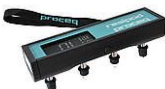
Resipod je potpuno integrisana 4-tačke Wenner sonda dizajnirana da meri specifičnu električnu otpornost betona u potpuno nedestruktivnom testu. To je najprecizniji instrument trenutno, ekstremno brz i stabilan i upakovan u izdržljivo vodootporno kućište dizajnirano da radi i u najzahtevnijim terenskim sredinama.
