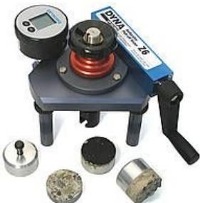
Dyna pull off tester je neophodan za dijagnostiku oštećenja građevinskih struktura kao i za kompletну proveru radova renoviranja. Dyna pull off tester se koristi za utvrđivanje površinske jačine betona i drugih materijala testiranjem direktno na komponenti omogućavajući primenu na bilo kojoj mernoj tački. Dodatno, Dyna pull off tester može se koristiti za merenje adhezivne jačine kod nanetih prokrivki kao što su plastični slojevi, betonski slojevi i malteri i gipsovi.
