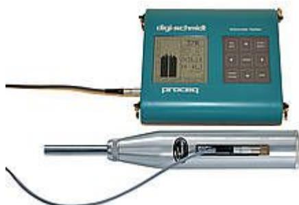
**Schmidt Hammer** Digi-Schmidt je razvijen za nedestruktivno merenje kompresivne jačine betona i kontrolu kvaliteta uniformnosti betona.
