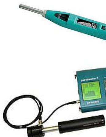
PaperSchmidt je prvi odskok čekić dizajniran specijalno za testiranje profila rolni. Brojni terenski testovi koji su izvršeni kod vodećih proizvođača u Americi i Evropi su dosledno pokazivali da PaperSchmidt nude dotada nedostigu preciznost i ponovljivost.
