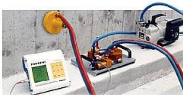
Torrent tester propustnosti dozvoljava brzo i nedestruktivno merenje kvaliteta sloja betona u pogledu dugotrajnosti. Propustnost betona je odličan indikator potencijalnog trajanja i otpornosti određenog betona na ulazak agresivnih tečnosti i gasova. merenje sa ovim testerom traje 2-12 minuta.
