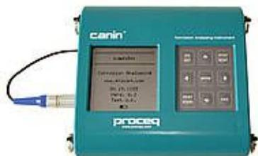
Analiza korozije omogućuje izvođačima radova da ograniče zadatke održavanja na armiranom betonu na oblasti gde je to stvarno potrebno. Canin<sup>+</sup> je najbrži instrument za analizu korozije, koji nudi praktični, ekonomični pristup analizi armiranog betona.
