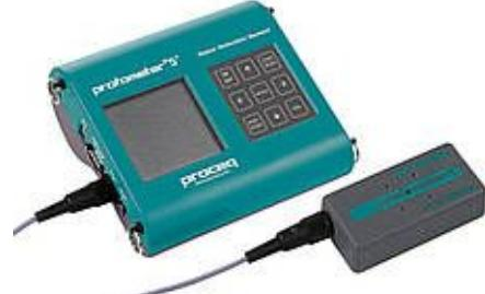
Profometer 5<sup>+</sup> je sofisticirani uređaj za nedestruktivno lociranje armature i za merenje betonskog sloja i dijametra šipki armature, upotrebom principa vrtložnih struja sa impulsnom indukcijom kao merni metod.
